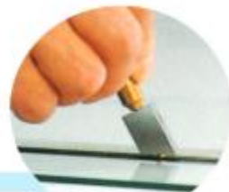
玻璃刀头上镶的金刚石 可用来裁玻璃
