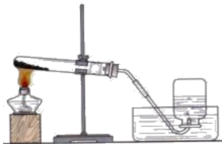
高锰酸钾制取氧气装置
