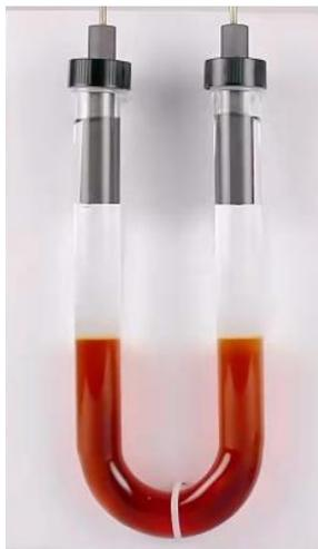
【实验现象】阴极附近颜色加深，阳极附近颜色变浅。
