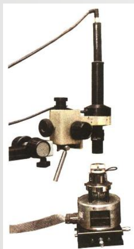
图6 扫描隧道显微镜 用于观察固体表面的原子排列情况等
