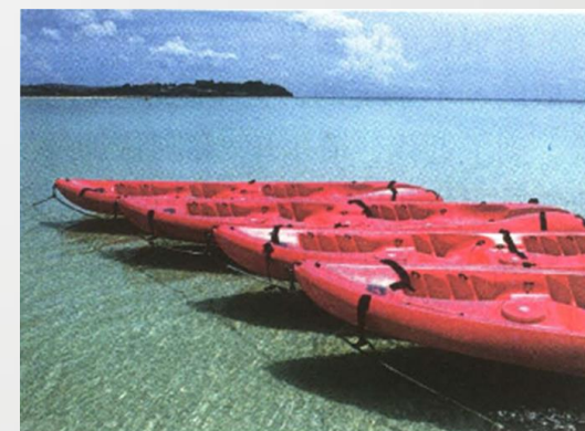
图10 用玻璃钢制成的船体
